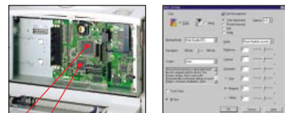
266-MHz-Prozessor und spezielles ASIC für die Umwandlung von RGB in CMYK.
