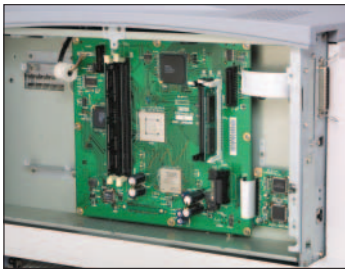
Kombinierte Leistung von 400 MHz-Prozessor und AcuLaser Colour ASIC
